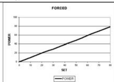
Графика на изходната мощност при ФОРСИРАНА КОАГУЛАЦИЯ при номинален товар
